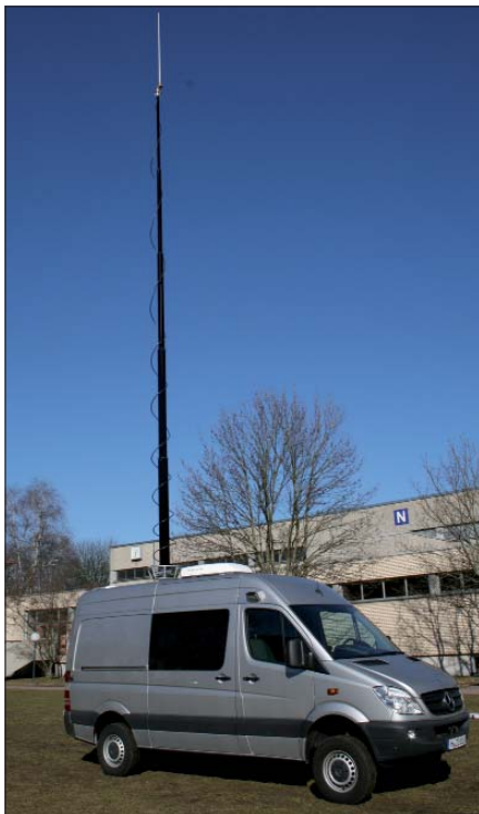
In Niedersachsen sind für die Belange der BOS in Fahrzeuge eingebaute mobile Basisstationen mit integriertem 12-m-Teleskopmast bereits im Einsatz (Foto: @ZPD Niedersachsen)
