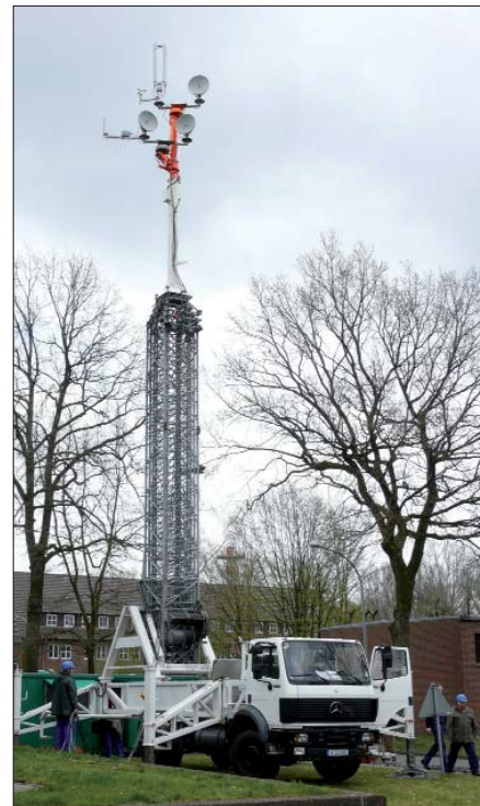
Ein 40-m-Teleskop-Richtfunkmast aus dem Arsenal der niedersächsischen Polizei kann sowohl als Antennenträger für die MBS dienen als auch für den Aufbau von Richtfunkverbindungen eingesetzt werden
